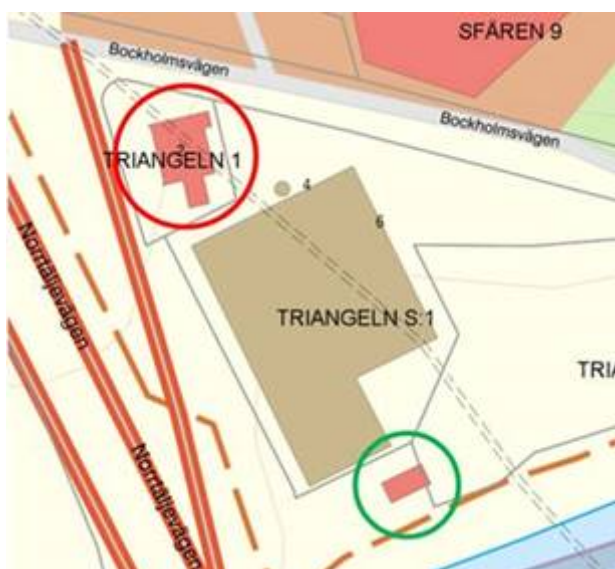
Figur 2 Bild som visar två teknikbyggnader i anslutning till planområdet. Byggnaden markerad med röd ring är en likriktarstation som tillhör trafikförvaltningen och byggnaden markerad med grön ring är Norrenergis byggnad som innehåller ett ställverk för matning av sjövattpumpar.
